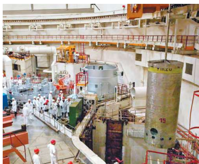
Реакторное отделение энергоблока № 3. Загружается контейнер с ядерным топливом для АЭС
