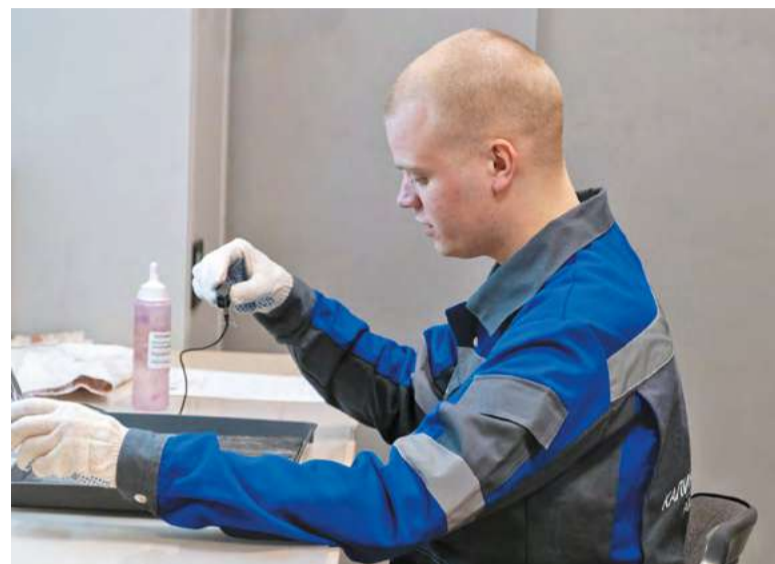
Павел Кононов, дефектоскопист рентгено-, гаммаграфирования ОДМиТК, в рамках конкурса «Лучший по профессии» выполняет контроль сварного соединения на представленном образце
